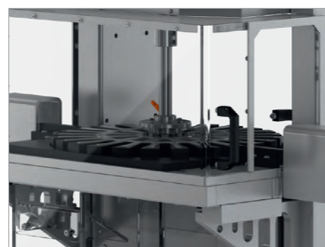
Sistema rotatório como opção de quatro pistas (HC-A-IS-Q)
